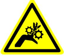
**MOVING COMPONENTS POSE CRUSHING AND ENTANGLEMENT HAZARDS.**
